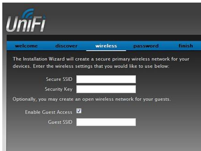
Рисунок 6.7 – Настройка точки доступа
