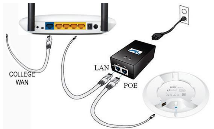
Рисунок 4.7 – Схема подключение. Подключение инжектора-Рое
