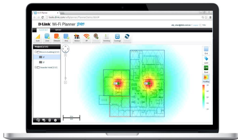
Рисунок 2.1 - Инструмент для радиочастотного моделирования, упрощающий проектирование беспроводных сетей
