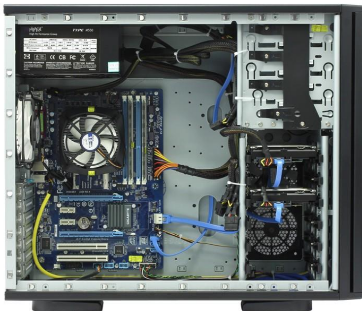
Рисунок 35 - Общий вид собранного системного блока в открытом виде
