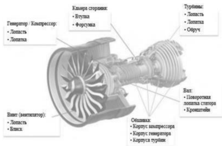
Рисунок 4. Конструкция ДУ с применением AM-технологий
